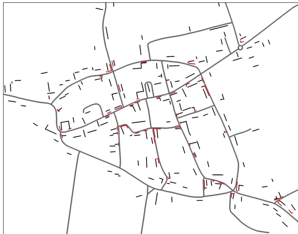
Schéma présentant l'organisation urbaine avec le tracé des voies (gris), sens de faitage des bâtiments (noir) et façade à l'alignement de l'espace public (rouge)
