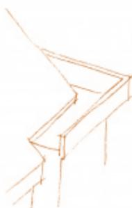
Exemple d'un acrotère sur une toiture à faible pente (source : Fncaue)
